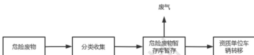
图 3-3 废漆料库项目储存工艺流程图
