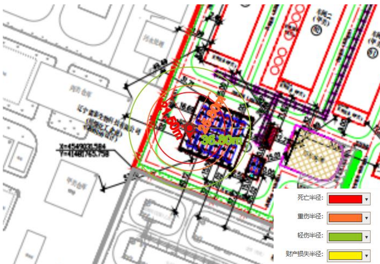
图 C.6-2 乙醇储罐池火灾事故后果模拟结果图
