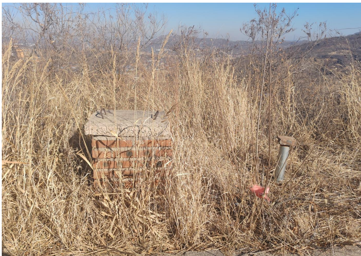
图 2-17 人工位移及浸润线监测设施
