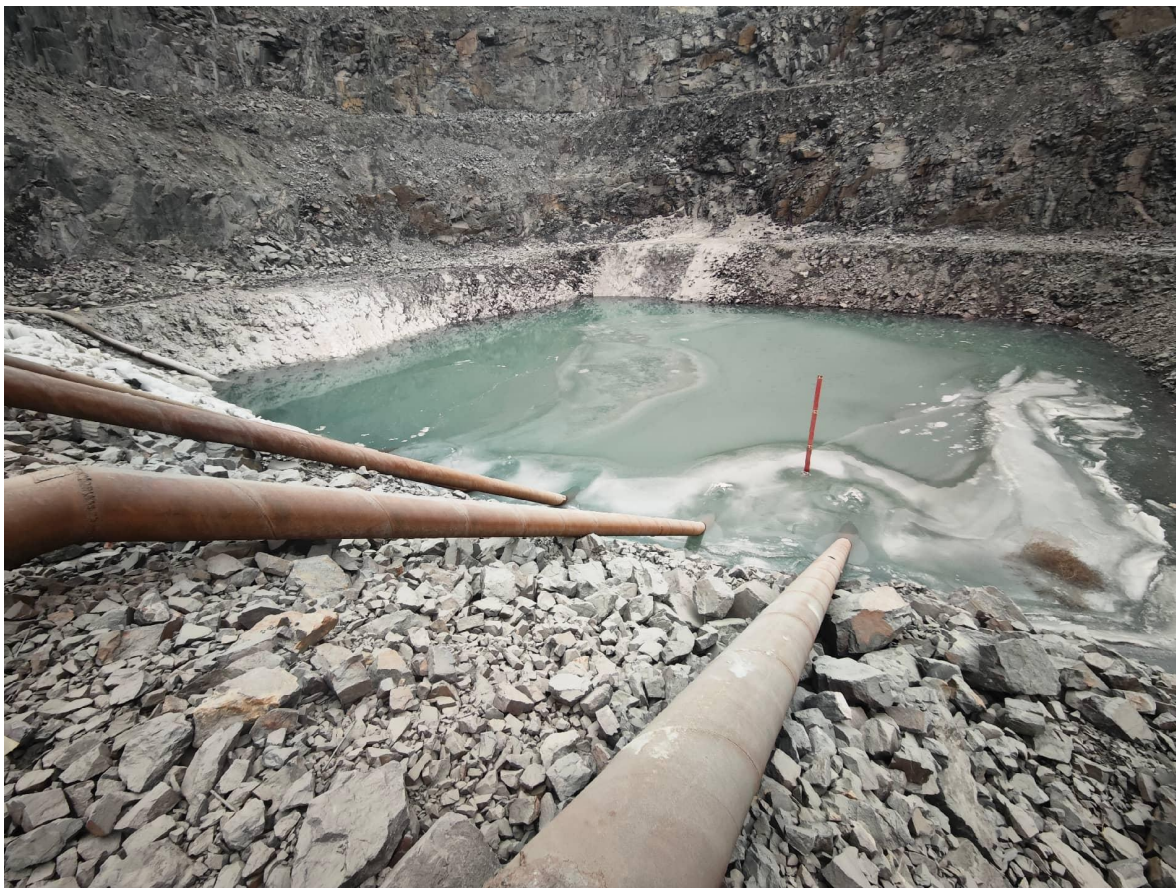
图 2.5.7-1 许东沟采区坑底移动泵站
